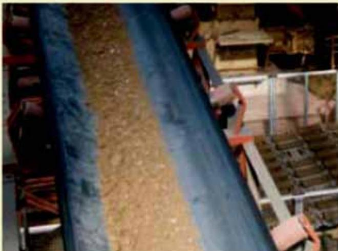
L'impasto di calcestruzzo delle tegole in cemento fa presa a temperatura ambiente. Nessuna necessità di forni di cottura che consumano energia e disperdono fumi e gas in atmosfera.
