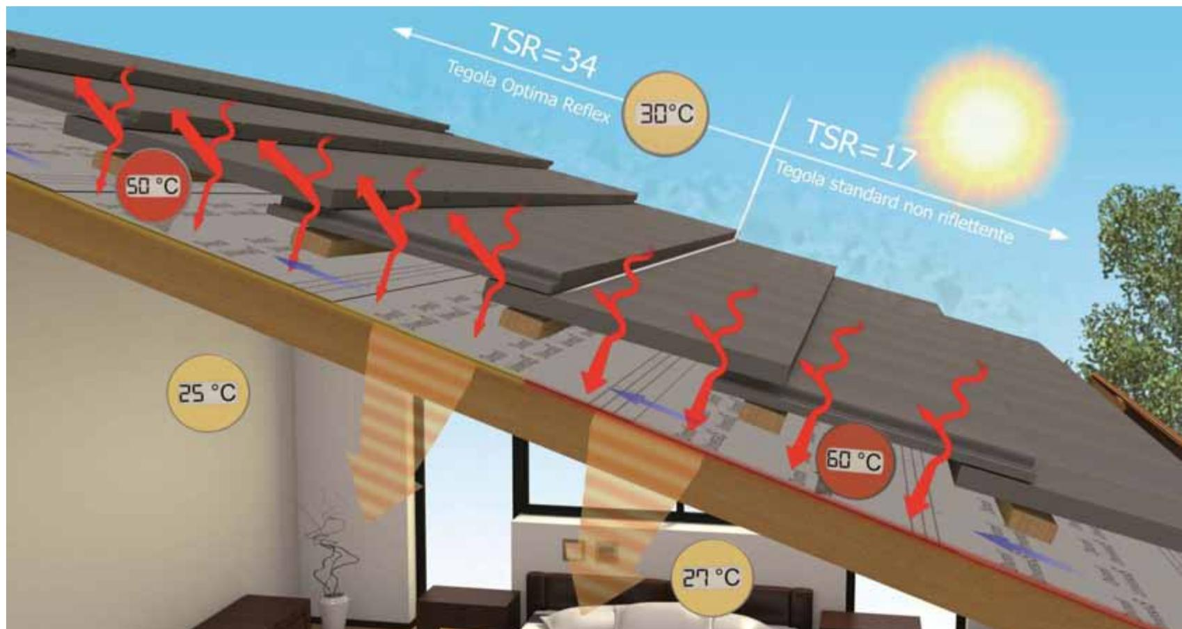
Il **beneficio all'interno dell'edificio** rispetto ad un tetto realizzato con tegole Tegal tradizionali (non riflettenti) dello stesso colore **è pari a 2°C** a parità di strato coibente (simulazioni eseguite per un tetto in legno e ipotizzando l'impiego del pannello in polistirene espanso estruso Unitherm di spessore 10 cm).
