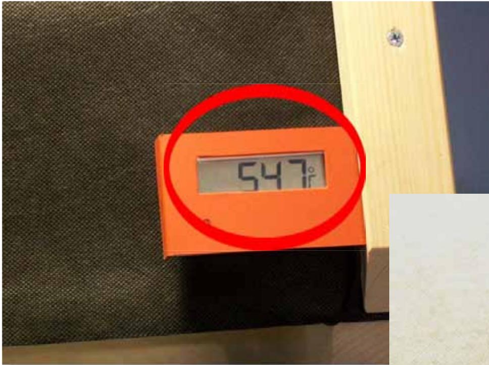
La temperatura rilevata al di sotto dello strato impermeabilizzante riflettente è di **13°C inferiore** rispetto alla prima: lo strato isolante dovrà abbattere una temperatura notevolmente più bassa
