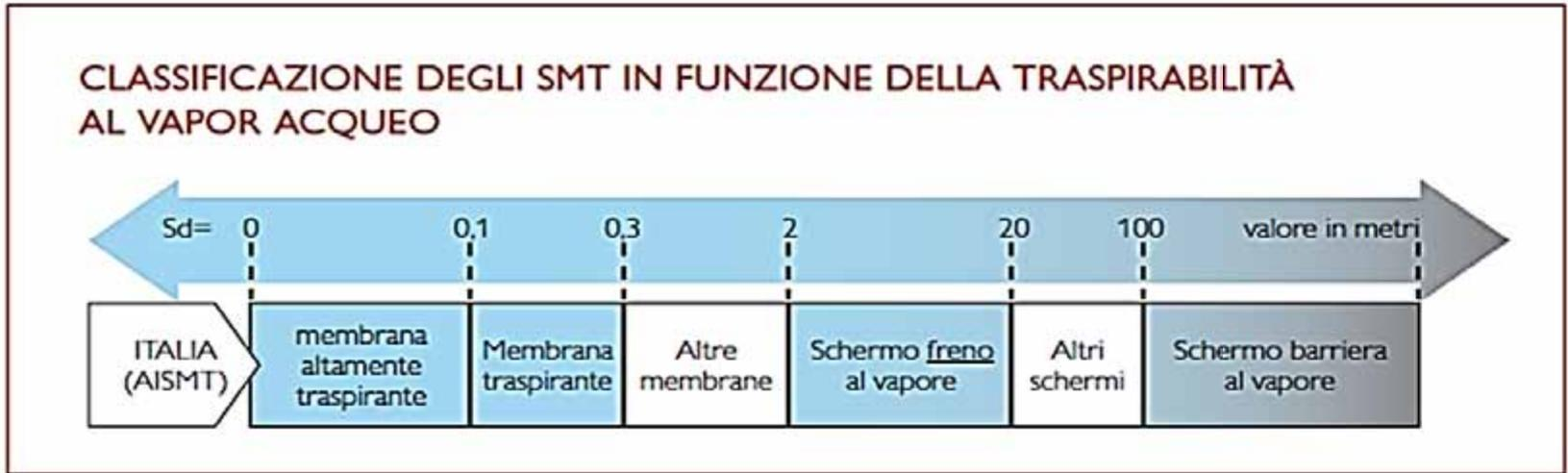
Sd = spessore di uno strato d'aria immobile che presenta la stessa resistenza alla diffusione del vapore del campione preso in esame. Il valore è espresso in metri. Sd elevato = bassa permeabilità al vapore; Sd basso = maggiore traspirabilità
