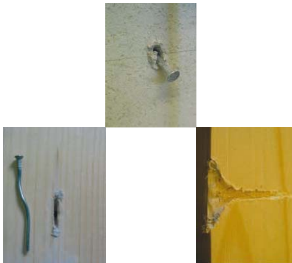
Deformazione plastica ed ovalizzazione del foro dopo uno sforzo ciclicodinamico della struttura. Lastre in gessofibra (in alto), sottostruttura in legno (destra), elementi di collegamento (sinistra).
